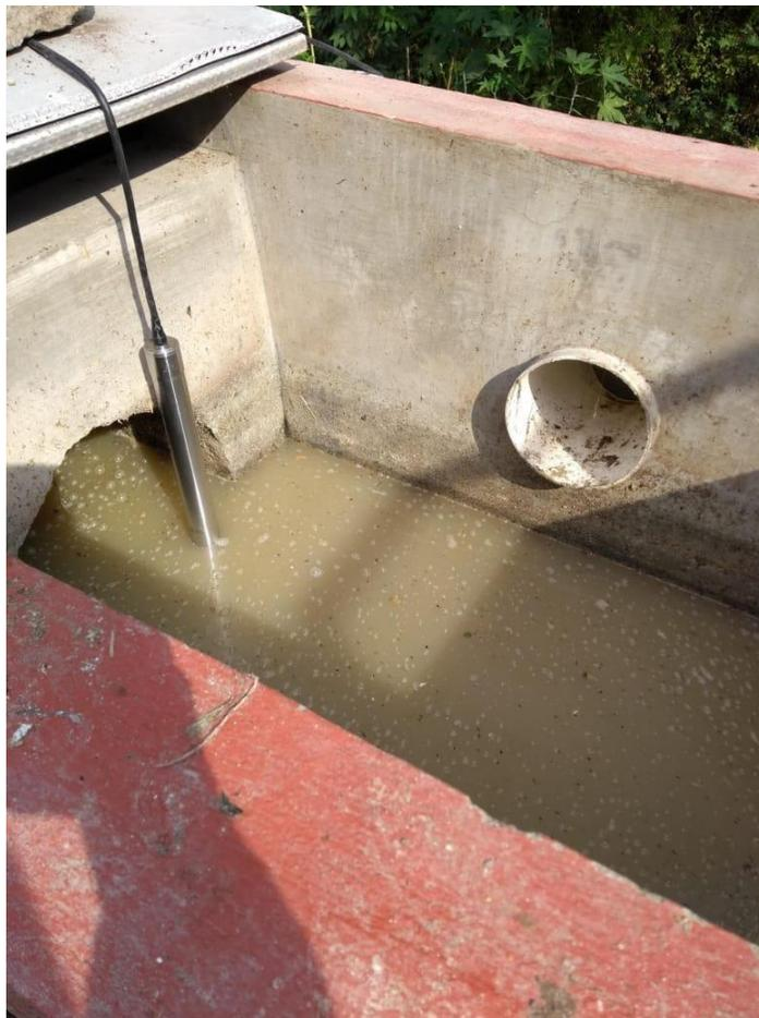
*Imagen 23. Sensor muestreando en afluente. PTAR San Ildefonso III.
